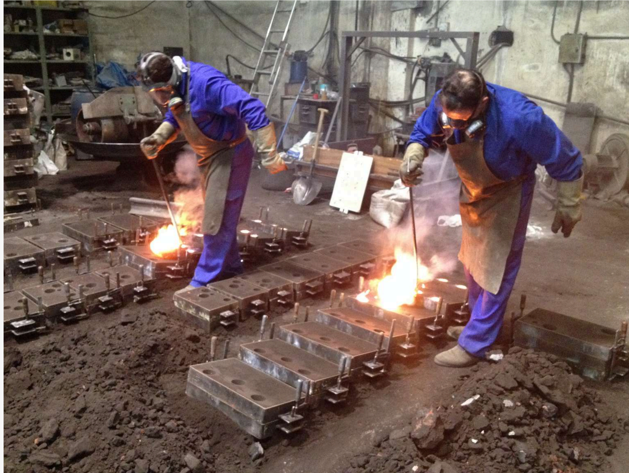
FUNDICIÓN A LA CERA PERDIDA EN TALLER DE METALISTERÍA
